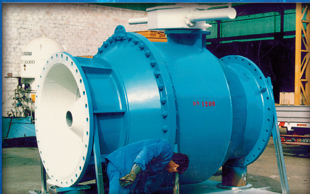
"CONSORZIO DI BONIFICA DI NARDO" LECCE / NEEDLE VALVE ND 1200 WITH HYDRAULIC ACTUATOR
